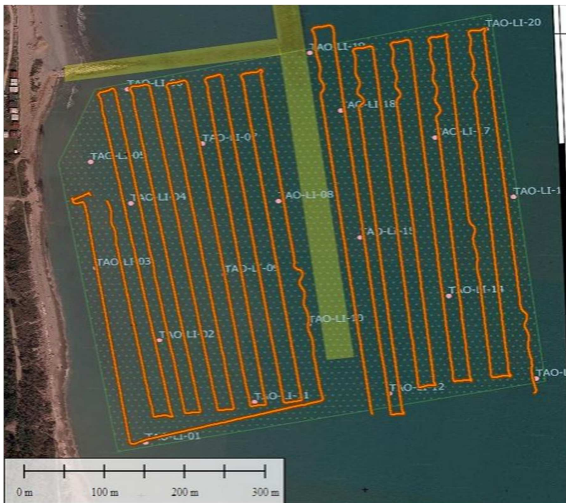
Figura 2. Rotte di navigazione del veicolo autonomo al sito di Lido di Dante realizzate per l'acquisizione dei dati geofisici. Base fotografica da OpenStreetMap ( www.openstreetmap.org )
