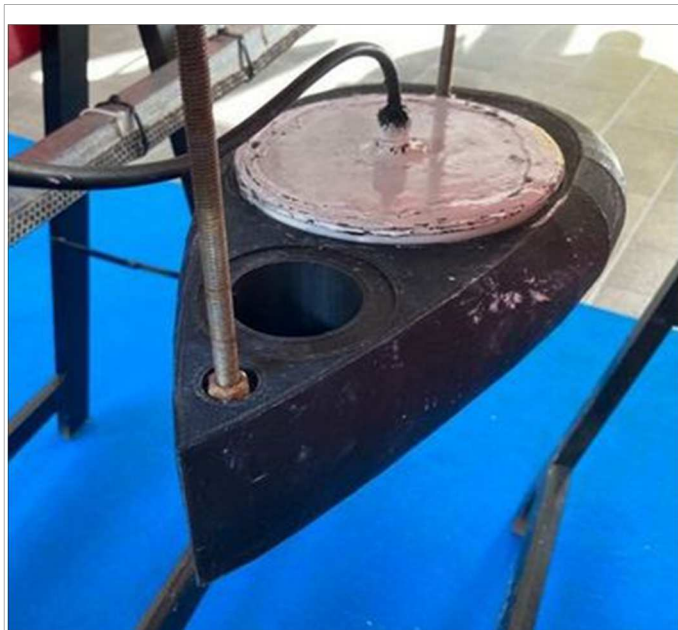
Figura 5. Prototipo del trasduttore Sub-bottom Profiler integrato al veicolo ed utilizzato per le campagne di acquisizione TAO
