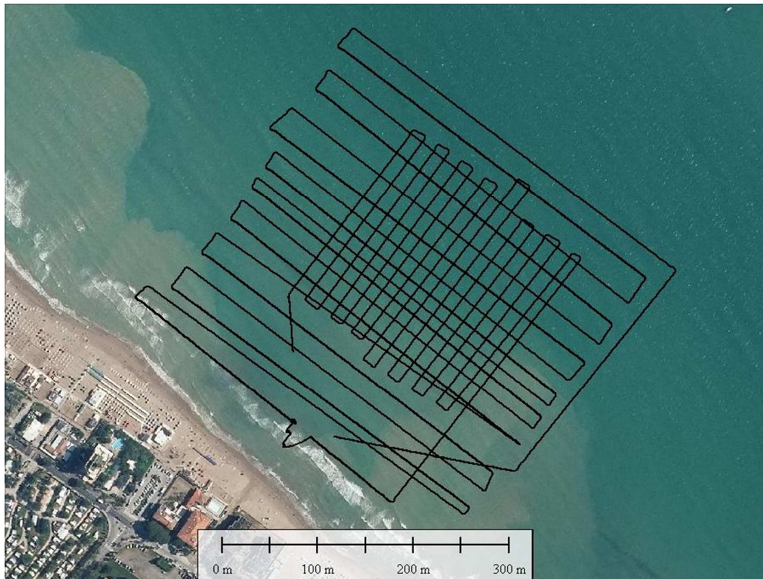
Figura 3. Rotte di navigazione del veicolo autonomo durante l'acquisizione dati relativa al sito di Riccione. Base fotografica da OpenStreetMap ( www.openstreetmap.org )
